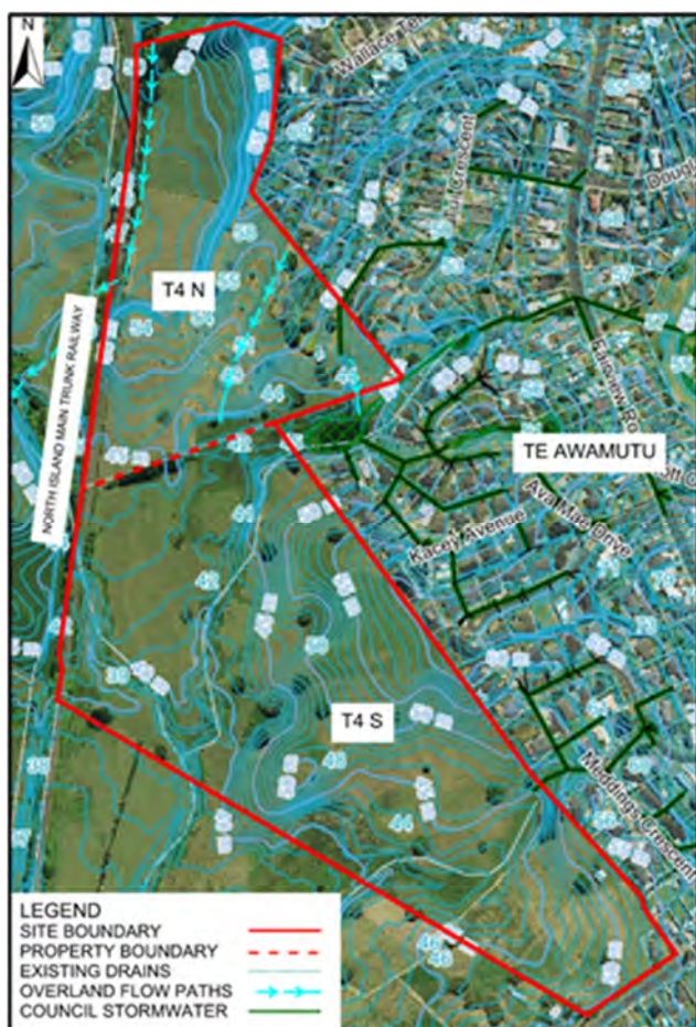
FIGURE 2 EXISTING DRAINS (WAIPA DC GIS MAPS)
